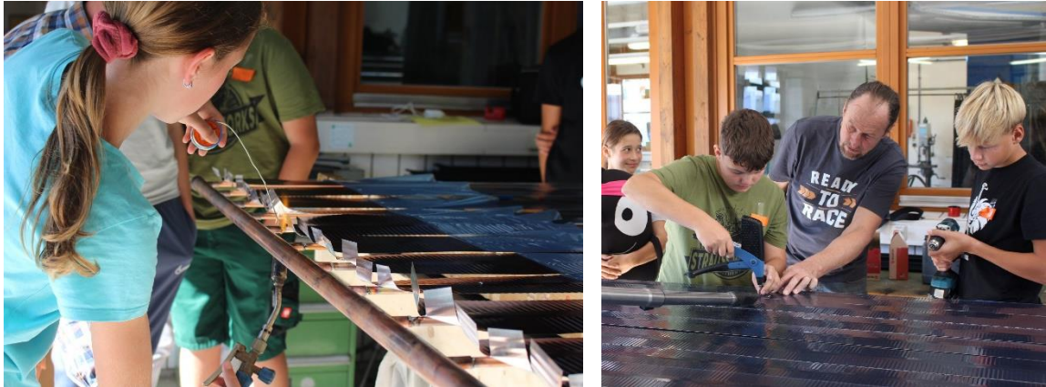
Abbildung 3 und 4: Solarcamp Hatzendorf: Absorber und Sammelrohre verlöten und vernieten © Laurin Greiter, Klimabündnis Steiermark
